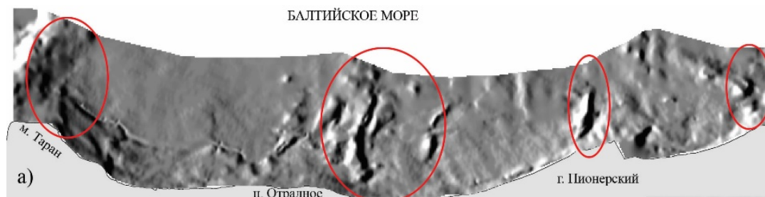
Рис.3 - Значения поперечного к берегу градиента рельефа подводного берегового склона для Светлогорской бухты (от мыса Таран до г. Пионерский). Овалами выделены районы с характерными поперечными положительными и отрицательными формами рельефа.
