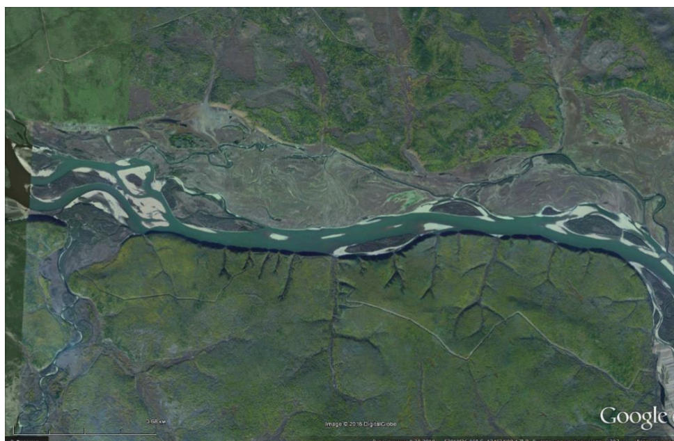
Рисунок 51. ПРК относительно прямолинейного адаптированного русла Амура с одиночными и односторонними разветвлениями с односторонней поймой
