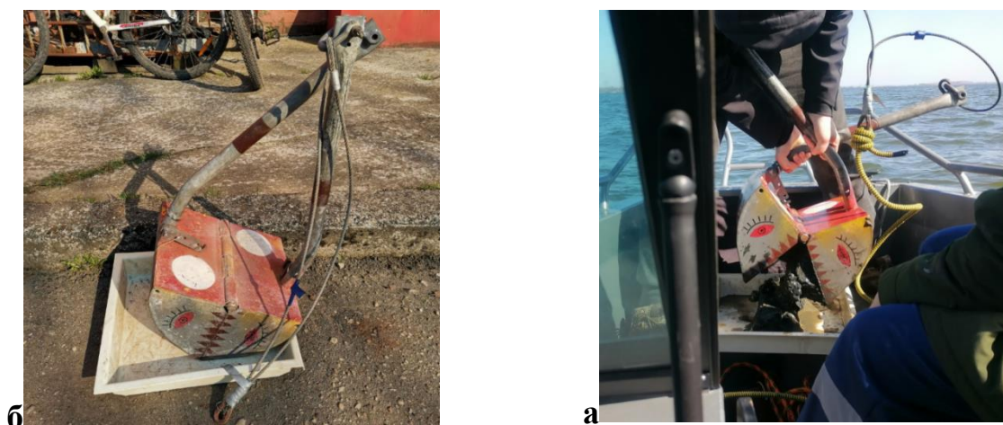
Рисунок 2.3 – Фото рабочего процесса: (а) – Ручной одноканатный грейферный ковш конструкции Ван Вина и пластиковый поддон для грунта; (б) – Рабочий процесс: вываливание грунта из ковша на поддон
