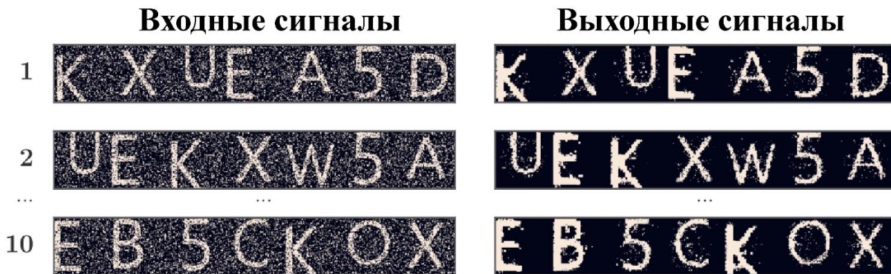
Рисунок 3.6 – Результаты тестирования функции кратковременной памяти в математической модели нейрон-астроцитарной сети. Показаны 3 цикла тестирования. На левой панели представлены тестовые сигналы, искаженные импульсным шумом с дисперсией 0.2. Правая панель – выходные сигналы математической модели нейрон-астроцитарной сети во время тестирования.
