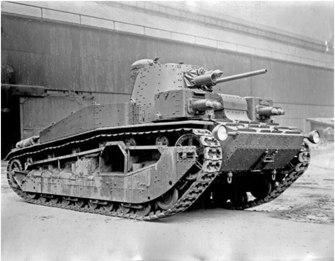
Рис. 19. Экспериментальный средний танк 16-тонный Vickers. 1927 г. Видно отсутствие приборов наблюдения механика-водителя. Источник: Royal Tank Regiment. URL: http://www.royaltankregiment.com (дата обращения: 09.12.2017).
