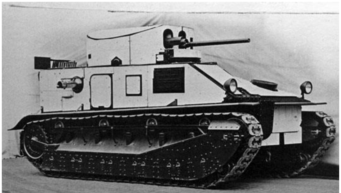
Рис. 20. Танк Medium Mk. II обшитый листами асбеста для теплоизоляции. Египет. 1930-е гг. Источник: Fletcher D. Mechanised Force: British Tanks Between the Wars. L.: H.M. Stationery Office, 1991. P.103
