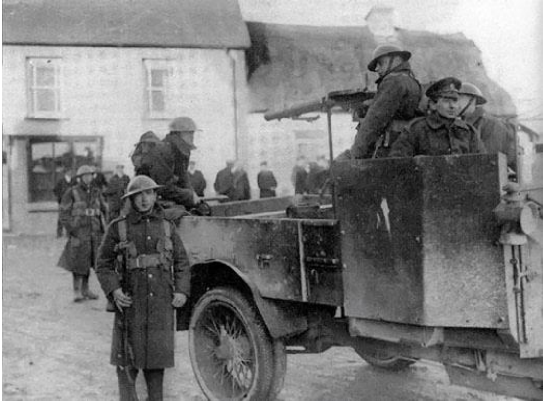
Рис. 5. Британский грузовой автомобиль, частично бронированный комплектом бронепанелей фабричного производства. Ирландия. 1921 г. Источник: The National Archives. The official archive and publisher for the UK Government, and for England and Wales. http://www.nationalarchives.gov.uk дата обращения: 01.07.2017).
