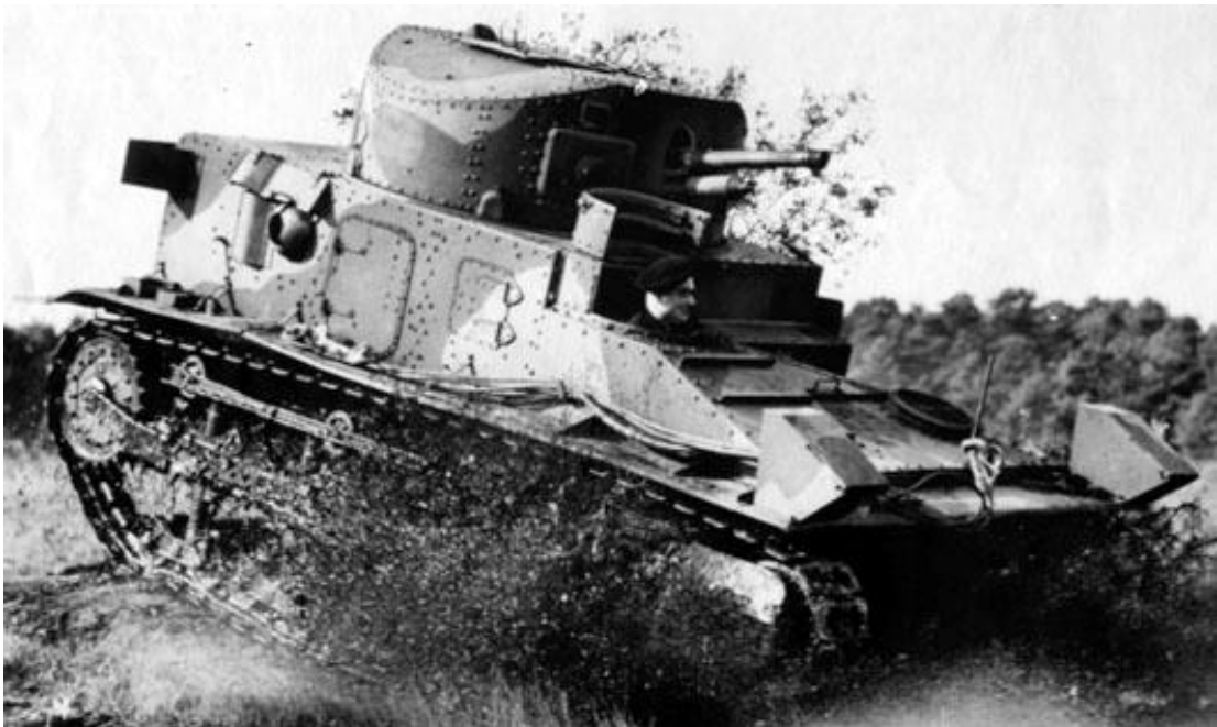
Рис. 7. Танк Medium Mk. I в движении. Видна конструкция люка механика-водителя и отсутствие защитного шлема у экипажа. 1920-е гг. Источник: The Tank Museum. Bovington. https://www.tankmuseum.org (дата обращения: 07.10.2016).
