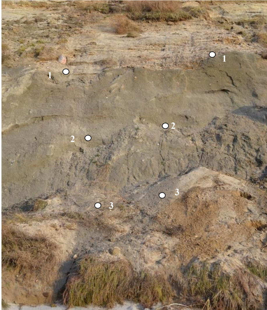
Рисунок 2.1.6 – Схема отбора проб с берегового уступа (точка 27 на Рисунке 2.1.4). Слева – осенняя съемка, справа – зимняя
