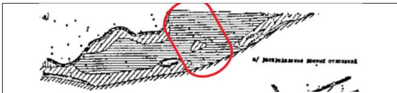
Рисунок 2.3 – Распределение донных отложений в Светлогорской бухте (юго-восточная Балтика) [Жиндарев, 1997]. Красным показано место ухода мелкозернистого песка на глубины 15-16 м.
