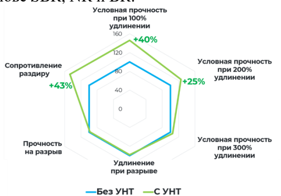
Рис.2 Влияние МУНТ на физико-механических свойств резин на основе SBR. Концентрат на основе МУНТ производства ИК СО РАН.
