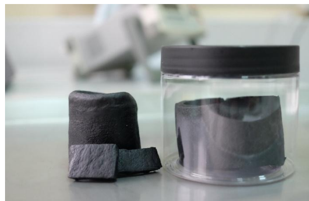
Рис.2 Влияние МУНТ на физико-механических свойств резин на основе SBR. Концентрат на основе МУНТ производства ИК СО РАН.
