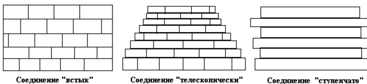
Рисунок. Типы соединений стальных листов резервуаров.
