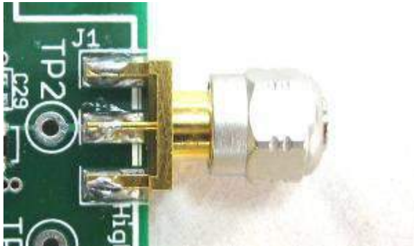
Рисунок 4. Оконечный резистор на 50 Ом с соединителем SMA
