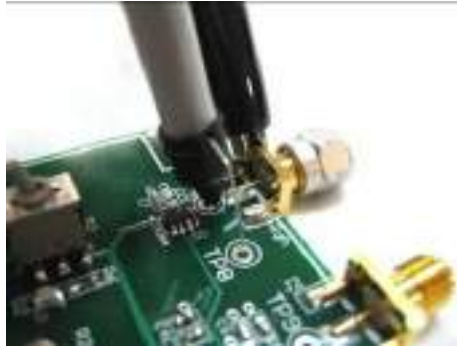
Рисунок 6. Щуп с пружинным контактом с «землей»
