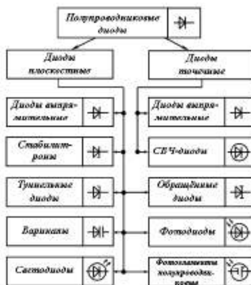
Рисунок 1 – Классификация и условные графические обозначения полупроводниковых диодов
