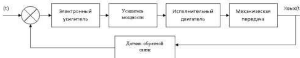
Рисунок 1.2 - Функциональная схема следящей системы привода подачи
