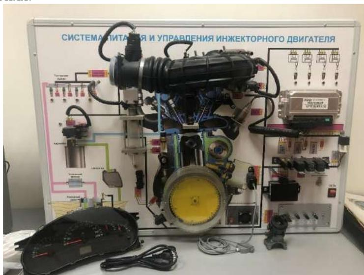
Рис.1 Лабораторный стенд-тренажер "Система управления инжекторного двигателя" СУИД-НР
