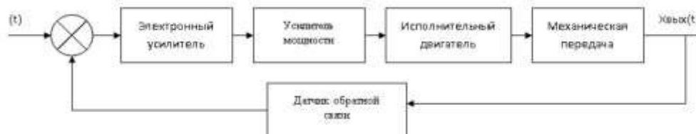
Рисунок 1.2 - Функциональная схема следящей системы привода подачи
