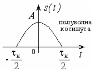
Рисунок 3.4 - Импульс вида полуволны косинуса, имеющий амплитуду A и длительность \tau_{И}
