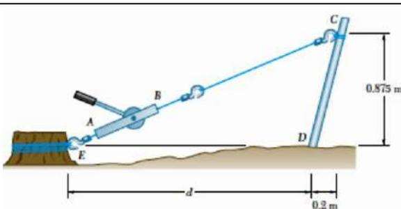
1. Для выпрямления столба забора используется лебедка АВ. Зная, что натяжение троса ВС составляет 1040 Н, а длина  $d=1,90$  м, определить момент относительно точки D силы, действующей со стороны троса в точке С с помощью разложения силы на горизонтальную и вертикальную составляющие.
