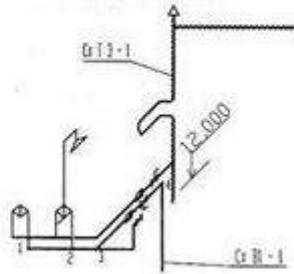
АКСНОМЕТРИЧЕСКАЯ СХЕМА КАНАЛИЗАЦИОННОГО СТОЯКА
