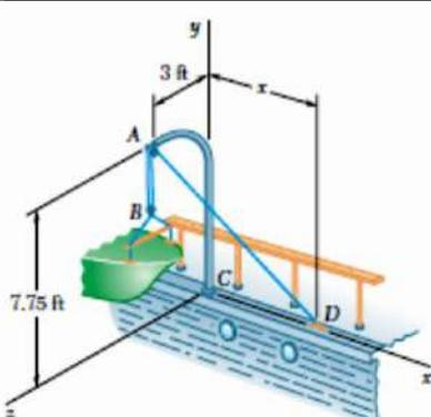
2. Маленькая лодка висит на двухшлюпбалках, одна из которых изображена на рисунке. Известно, что момент относительно оси z результирующей силы  $R_A$ , возникающей в балке в точке А, не должен превышать 279 Нм. Определите наибольшее допустимое натяжение троса АВАД если  $x=6$  м
