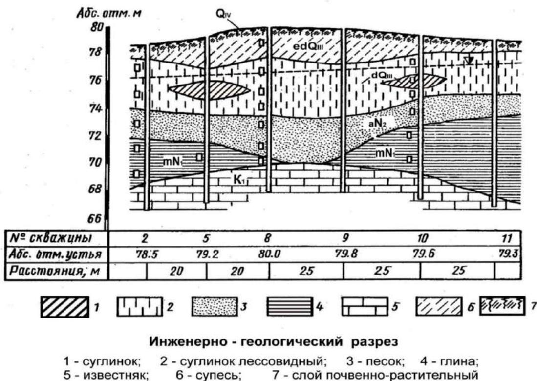
Рисунок - Инженерно-геологический разрез
