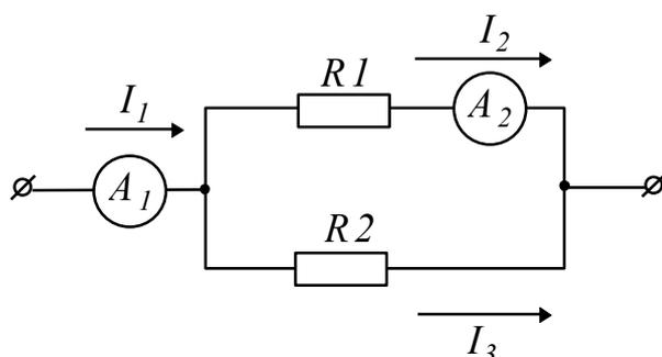
$A_1$  типа М330 с пределом измерения  $I_{K1} = 20\text{A}$ ;
