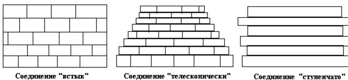
Рисунок. Типы соединений стальных листов резервуаров.
