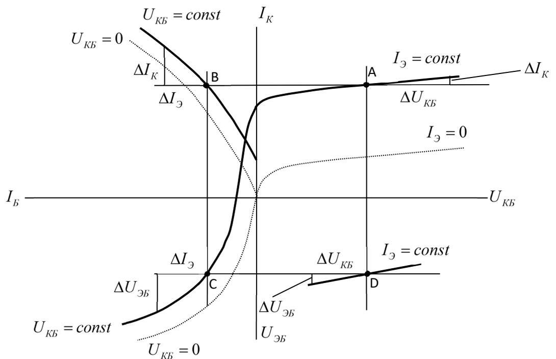
Рис. 5. Статические характеристики транзистора в схеме ОБ
