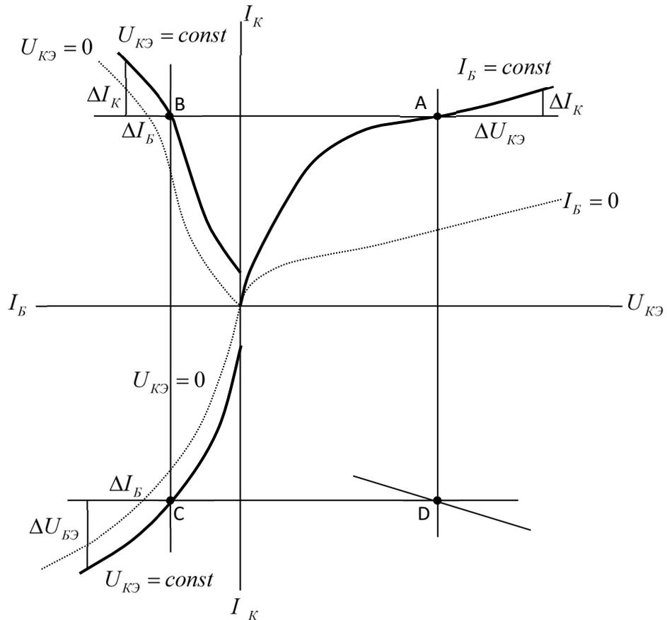
Рис. 6. Статические характеристики транзистора в схеме ОЭ.
