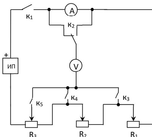
Рис. 2 Схема для исследования влияния сопротивления
