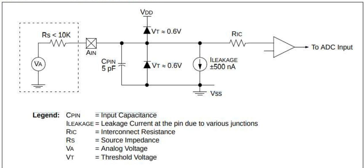
*Рисунок 1: Структурная схема АЦП микроконтроллера PIC16F688 (для справки)*
