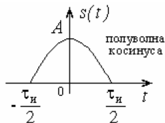
Рисунок 3.4 - Импульс вида полуволны косинуса, имеющий амплитуду A и длительность \tau_{\text{И}}
