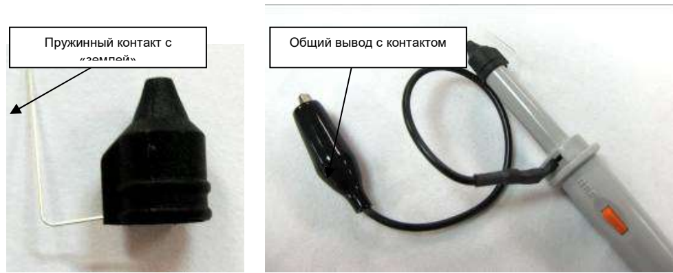
Рисунок 3. Щуп с общим проводом/выводом и пружинный контакт с «землей»
