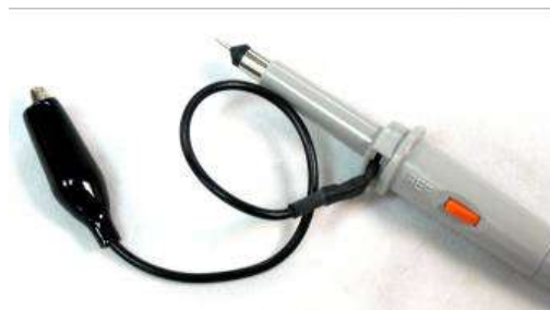
Рисунок 2. Датчик с общим проводом/выводом
