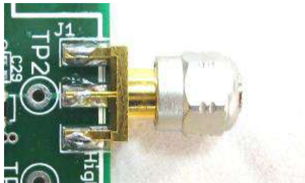
Рисунок 4. Оконечный резистор на 50 Ом с соединителем SMA
