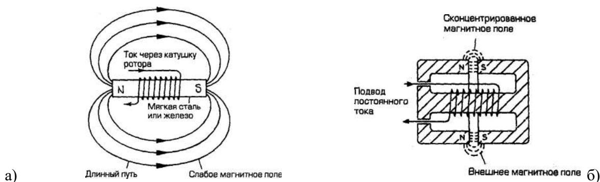
Рис 7. Схемы электромагнита: а) простого; б) со сближенными полюсами.
