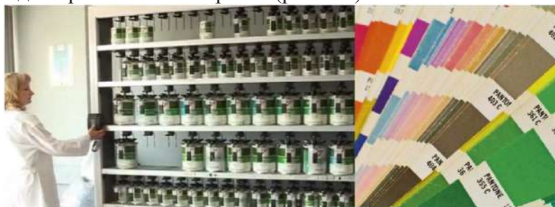
Рис. 4.1. Установка для смешивания красок и эталоны цвета
