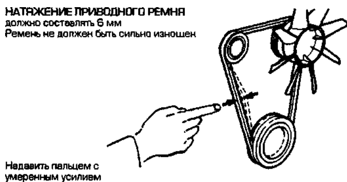
Рис 1. Проверка натяжного ремня.
